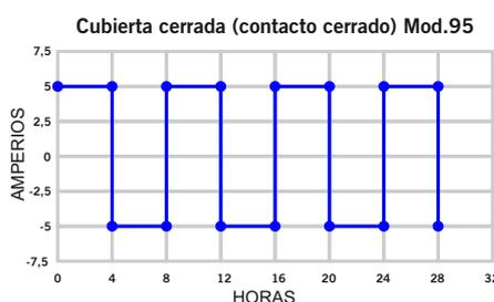
Quando la cubierta esté cerrada sobre el vaso, la intensidad de producción del aparato se reducirá en un 50%. Un aparato ajustado a 10A no producirá más de 5A (Mod.95) con la cubierta cerrada.
