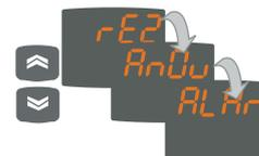
• Use las teclas 'UP' y 'DOWN' para recorrer las carpetas del nivel de usuario y pulse la tecla 'set' para acceder a los parámetros de la carpeta seleccionada (por ejemplo: carpeta **ALAr**).
