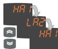
Si hay alarmas, pulse las teclas UP y DOWN para verlas y seleccionarlas.
